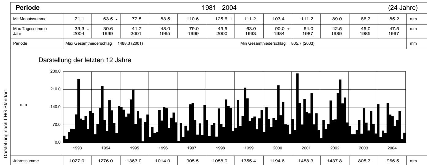
Ab 8. Sep. 2000 Logger-Aufzeichnung mit Kippwaage und geheiztem Auffanggefäß (erhöhte Messgenauigkeit)
